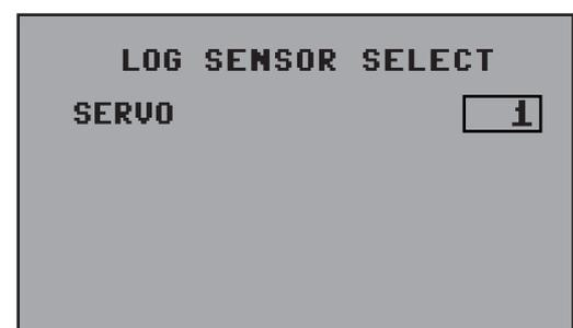
Hier werden die Geräte angezeigt, deren Daten über die Bluetooth Schnittstelle ausgegeben werden um Sie z.B. im Live Log des Firmware Upgrade Studio anzuzeigen. Dazu muß das optionale Bluetooth Modul S8351 verwendet werden. Die Einstellungen für die Datenübertragung werden im Versteckten Modus eingestellt (siehe Kapitel Hidden mode).
