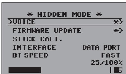
In den versteckten Modus (HIDDEN MODE) gelangen Sie durch gleichzeitiges drücken der **UP** und **DOWN** Tasten aus dem Hauptbild. Hier können Sie dann die Sprachdateien oder ein Firmwareupdate von der SD Karte laden. Ausserdem können Sie hier die Knüppelkalibrierung vornehmen.
