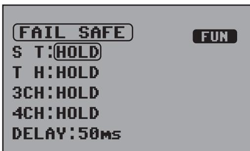
In diesem Menü können Sie die Fail Safe Einstellungen für jeden Kanal einzeln vornehmen. Diese Funktion bringt das Servo des jeweiligen Kanals, bei einem Signalverlust des Empfängers, in eine vorbestimmte Position. Es kann z.B. das Gasservo bei einem Verbrennermodell für diesen Fall auf Leerlauf gestellt werden (beim Elektromodell auf Motor-Aus), damit das Modell nicht unkontrolliert weiter fährt.
