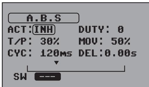
In diesem Menü kann die A.B.S Funktion eingestellt werden. Das A.B.S. ermöglicht ein besseres Bremsverhalten, da die Bremse hier impulsweise betätigt wird.
