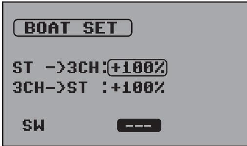
Mit diesen Mischern kann z.B. ein zweiter Antrieb (ESC) angesteuert werden
