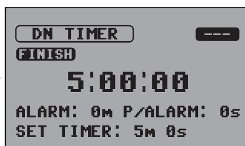
Die Timerfunktion wird durch die Zuweisung von Schaltern im SW FUN Menü gestartet oder gestoppt. Dabei wird die Funktion folgendermaßen ausgeführt:
