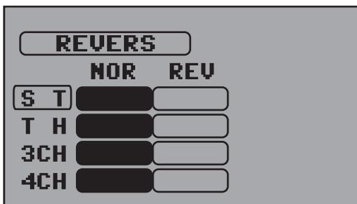
In diesem Menü wird die Servodrehrichtung für den jeweiligen Kanal eingestellt.
